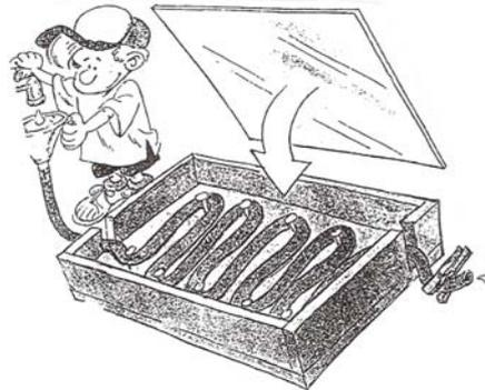
Abbildung 3-1: Thermische Solaranlage
